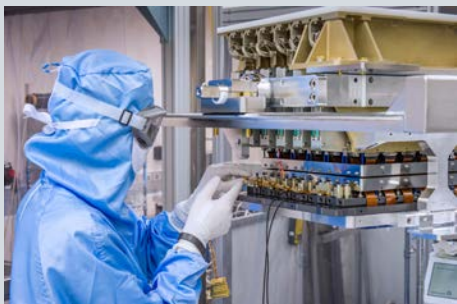
Intégration du plan focal de l'instrument VIS de la mission Euclid
