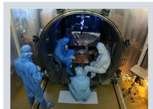
Station d'étalonnage: le grand simulateur Jupiter pour les tests d'instruments spatiaux
